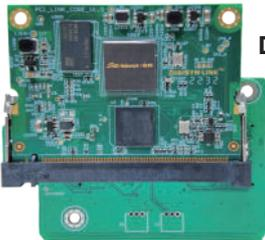
DL-08(Mini-PCI)模块，按照转接板卡槽位置插在板上即可。
