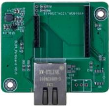
DL-04 模块两排针脚数量不同，按照对应的插在转接板上即可。DL-04 转接板上带有一个网络接口，此接口为 DL-04 模块联网用，在使用 DL-04 模块及转接板时，需要使用转接板上面的网口联网，不能用开发板上面的网口联网。
